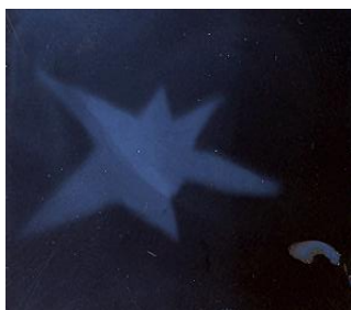
Abb. 4.16: Röntgenbild eines mit nur einer Rolle Scotch-Tape belichteten Sterns
