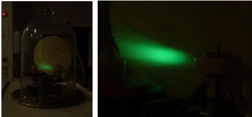
Abb. 4.6: Auch ein Röntgenschirm leuchtet beim Abrollen des Klebebandes
