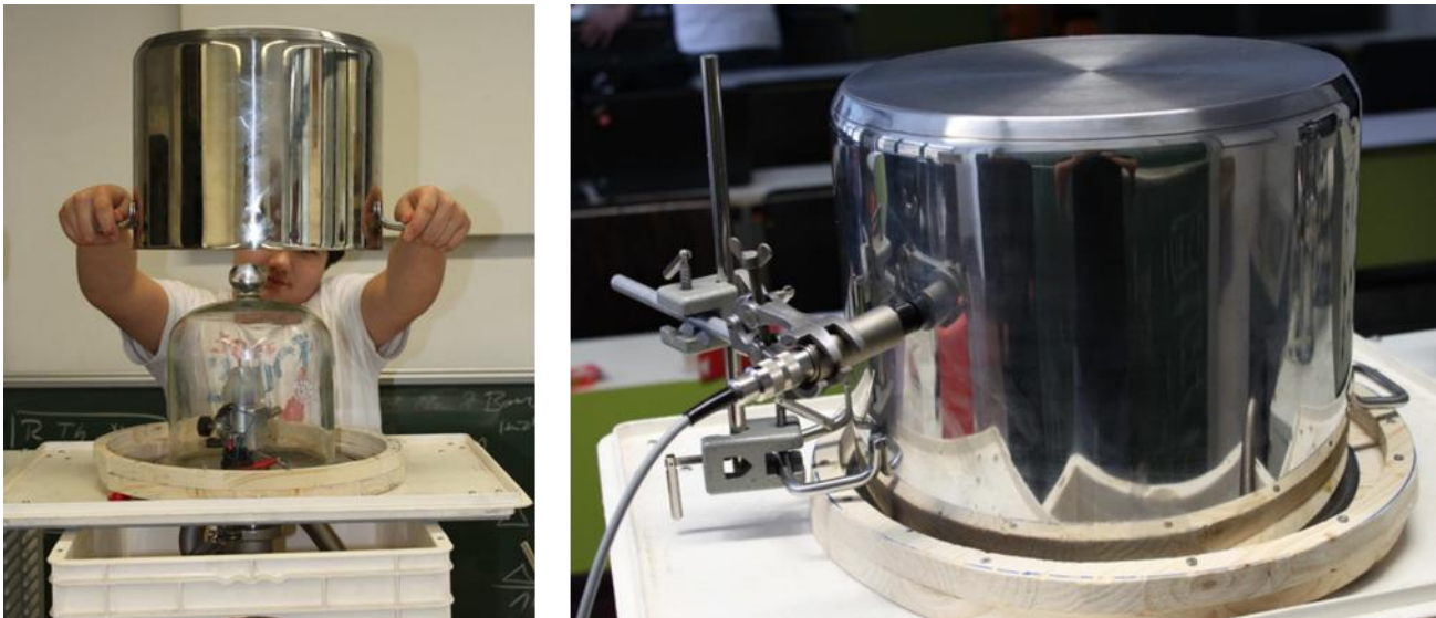
Abb. 4.11: Topf als Strahlen- und Splitterschutz
