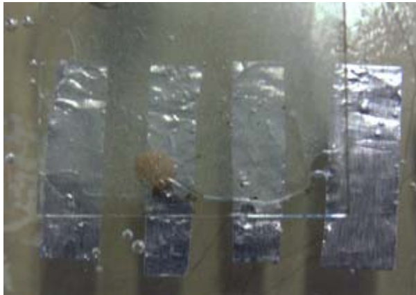
Abb. 7.1 Ein Zeolithkügelchen unter der ITO-Elektrode (Durchmesser ca. 2mm)
