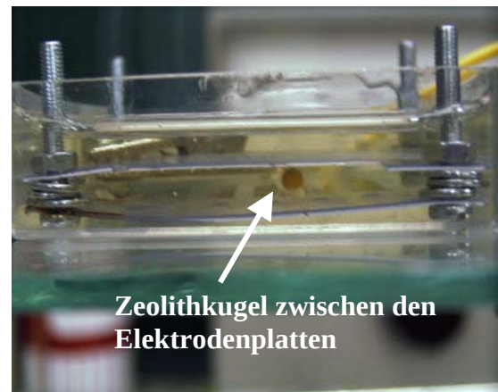
Abb. 4.4 Seitenansicht der Apparatur mit einer Zeolithkugel in einem mit Öl gefüllten Kunststoffbehälter.
