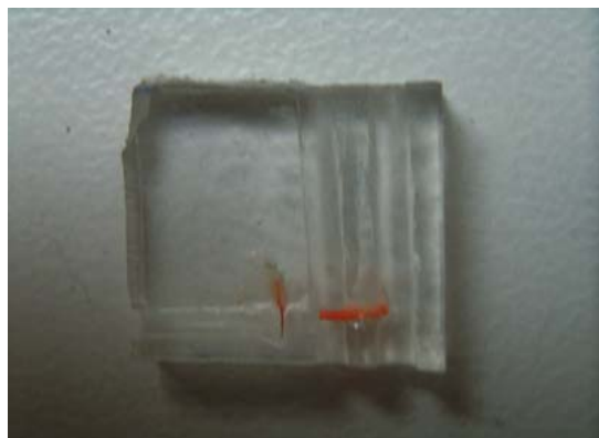
Abb. 5.4 Die gefräste Pumpe mit den Ventilen (noch ohne Deckel)
