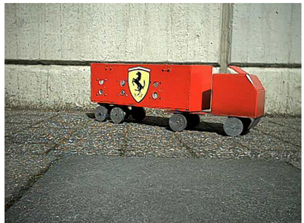
Abb. 5.2 : Der „Technik – LKW“ mit den drei Ultraschallsensoren
